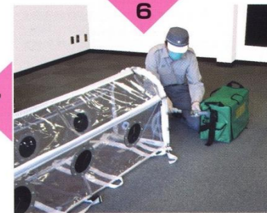
■カプセル側吸引ホースと殺菌装置を結合して搬送準備完了。組立は一人でも数分で可能。
